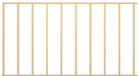
Osová vzdálenost spodní konstrukce max. 500 mm
