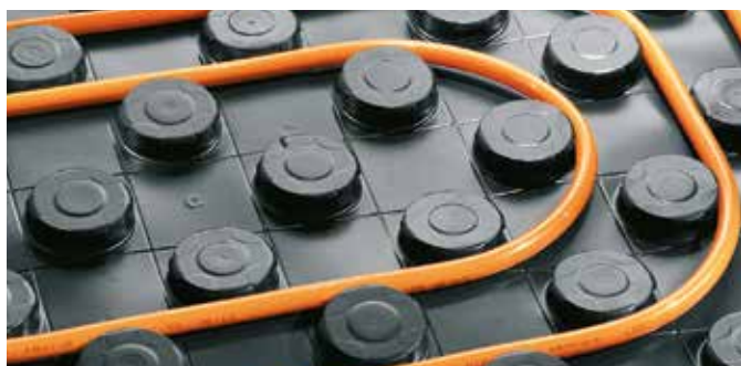
9. Minimální poloměr oblouku: okolo 3 výstupků při ohybu o 180°, příp. okolo 2 výstupků při ohybu o 90°. Pozor: Platí jen u desek s roztečí RA 75 mm. U desek RA 50 mm je nutno postupovat individuálně. Nikdy nesmí dojít při instalaci k prolomení trubky. Pokud k tomu dojde je nutno trubku v místě poškození vystříhnout.
