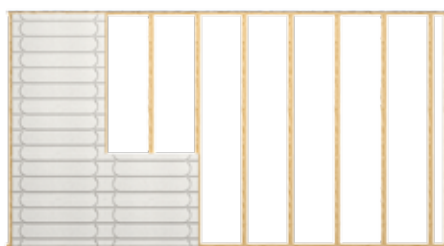
Montáž Therm 25 do spodní konstrukce (šrouby 40 mm nebo sponky 50 mm)
