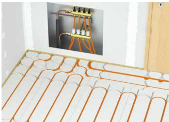
Pukový prvek Therm 25 před rozdělovačem topných okruhů s přefrézovanými drážkami
